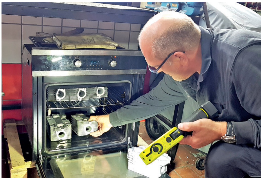
Wulf Keilmann schiebt die Zylinderköpfe in den Ofen. Diese werden jetzt ordentlich erhitzt – auf rund 200 Grad –, damit die Führungsbuchsen eingesetzt werden können. Pizza kann man natürlich auch machen ...
