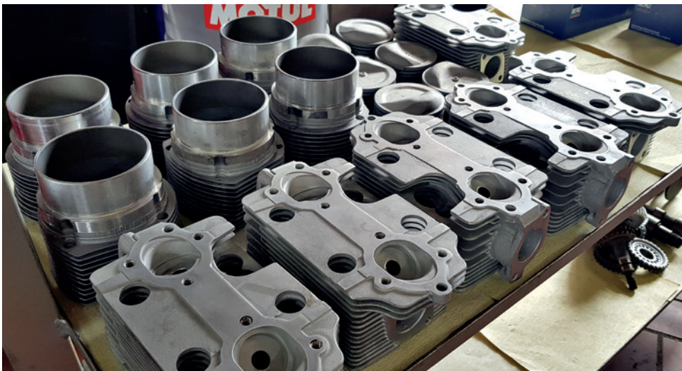
Kolbenbuchsen und Zylinderköpfe: gestrahlt und sauber. Die alten Ventilverführsbuchsen sind bereits herausgepresst.
