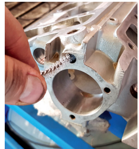
Unabdingbares Werkzeug: Pfeifenreiniger und kleine Bürsten. Jeden Ölkanal habe ich mir vorgenommen, durchgebürstet und ausgeblasen.
