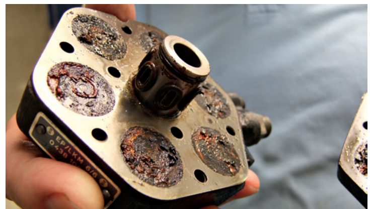
Hans Küppers hat's auf dem Tisch: Die Einzelteile der K-Jetronic kommen in seine Obhut. Nach Möglichkeit werden alle Originalteile überholt, sind welche nicht zu retten, werden sie ersetzt.
